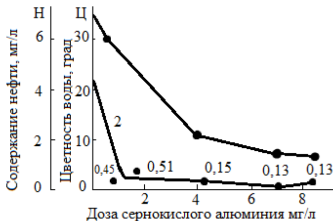
Рис. 1 График влияние доз коагулянта на обесцвечивание воды и удалений нефти:
