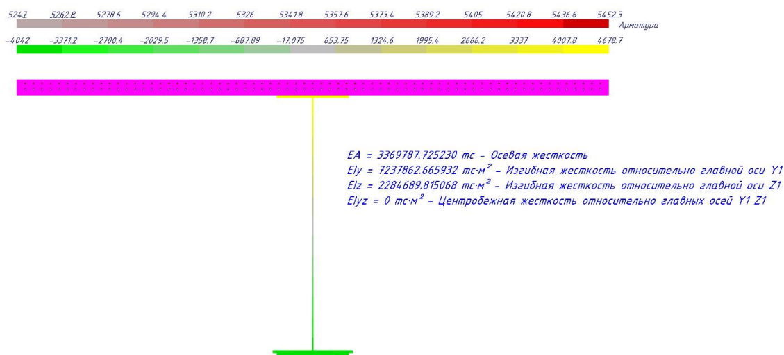
Рис. 3.6. Изополя напряжений в сталежелезобетонном сечении при отрицательном изгибающем моменте, достаточном для выключения ЖБ плиты из работы
