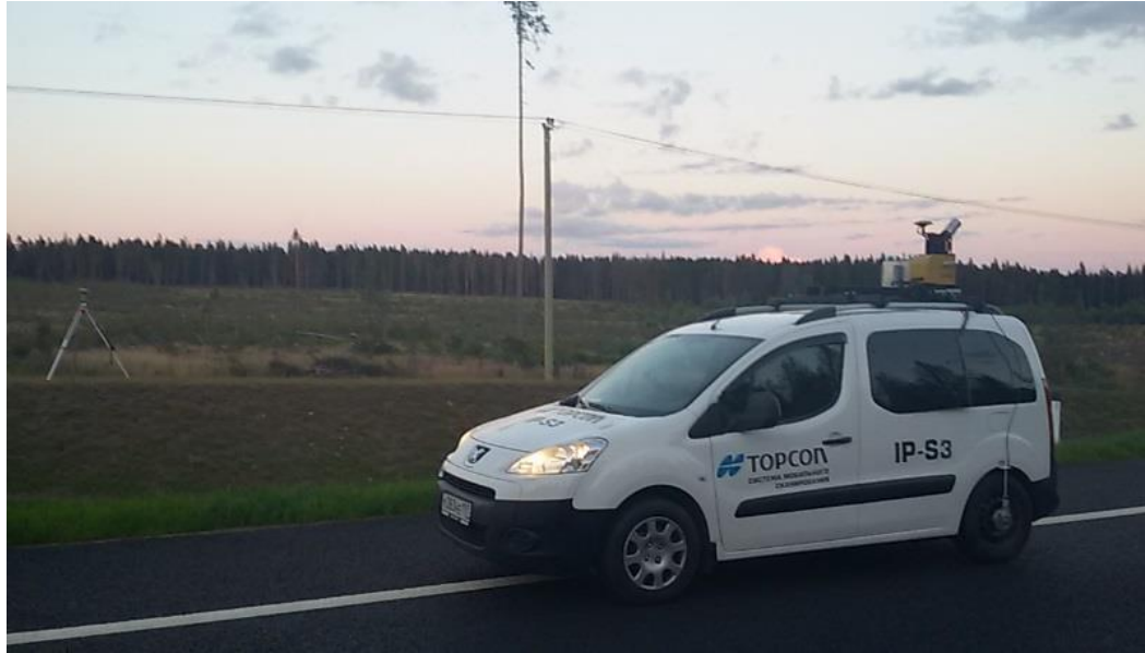
Система мобильного сканирования Торсон IP-S3
